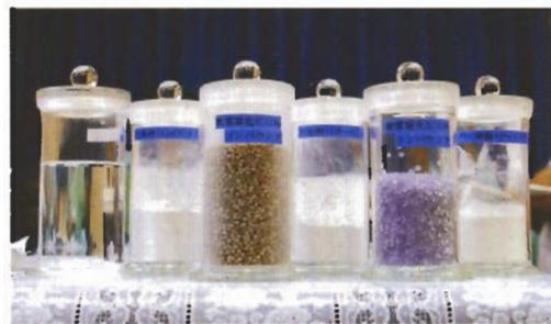
■左から可塑剤、充填剤、軟質塩ビコンパウンド、安定剤、硬質塩ビコンパウンド、塩化ビニル樹脂
